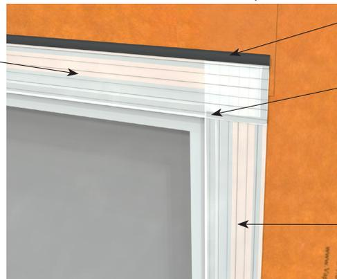
Joint en congé créé en travaillant VaproBond sur le bord supérieur de la bande de transition VaproSilicone.
