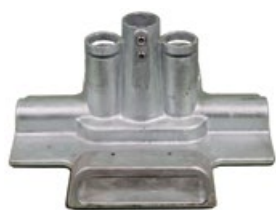
EAA05-01 : base en fonte avec galvanisation à chaud et membrane EPDM de .120" (3 mm) collée
